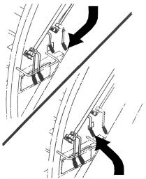
FOR ARM MECHANISM OR ROLL BAR: PULL LEVER TO RAISE CONTAINER. PUSH LEVER TO LOWER CONTAINER
