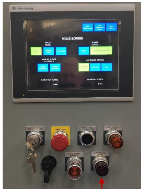
Si le conteneur a été remplacé et que le fait d'appuyer sur le bouton-poussoir rouge « Container Gone » (Conteneur disparu) ne réinitialise pas le voyant rouge allumé, inspectez le capteur du « Conteneur Gone » (Conteneur disparu) pour tout dommage. Le capteur se trouve sur le corps de la trémie du compacteur. Si aucun dommage n'est trouvé, appelez le Service technique de Marathon au 1 877 258-1105.
