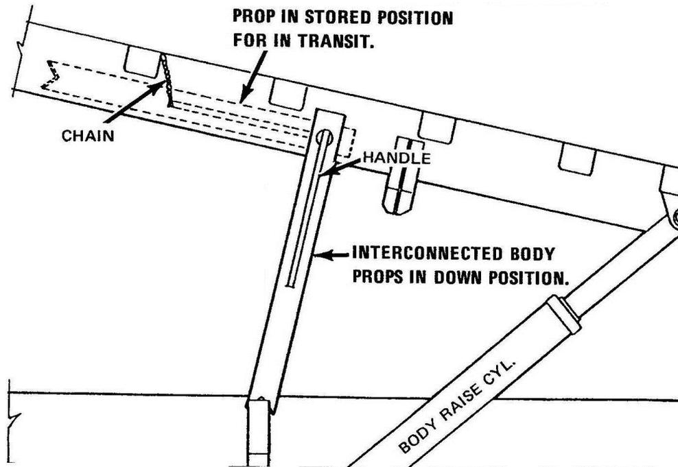
Figure 27. Factory Body Props
