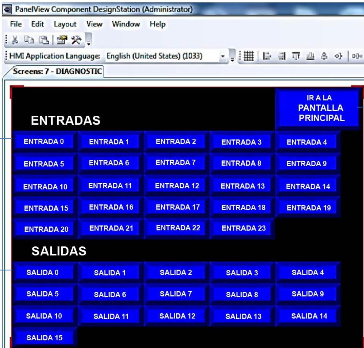
1. INDICADOR DE ENTRADA (INPUT INDICATOR). Los indicadores de entrada muestran el estado de las entradas en el PLC. Si una entrada está en su correspondiente indicador, se iluminará en verde.
