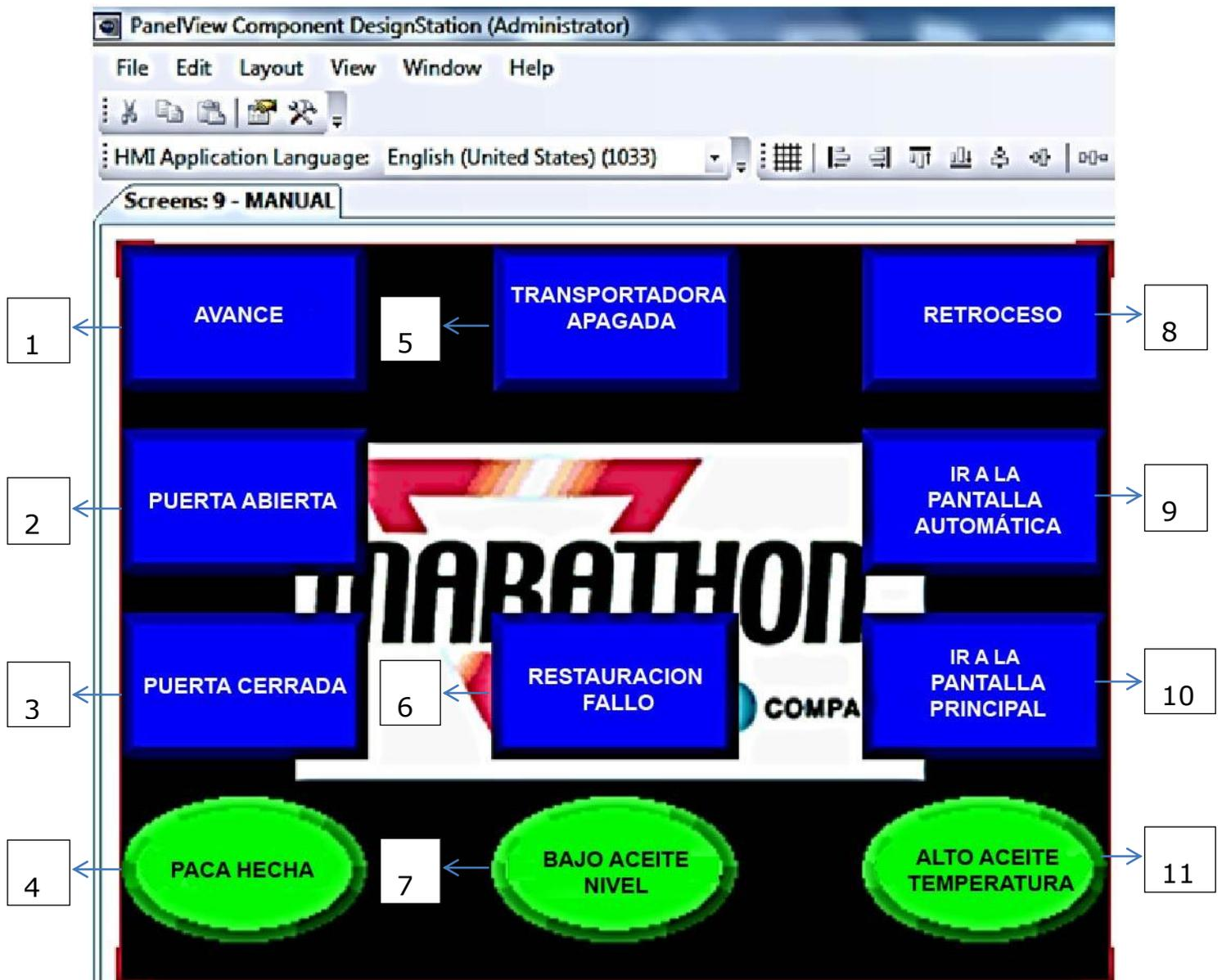
1. AVANCE (FORWARD). Al tocar el Avance (Forward), la empacadora se iniciará y el cilindro principal seguirá avanzando. Si el botón de Avance se mantiene apretado, el cilindro se extenderá hasta llegar al final del recorrido del cilindro.
