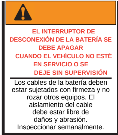
Figura 51. Advertencia: interruptor de desconexión de la batería, NP 212-2875
