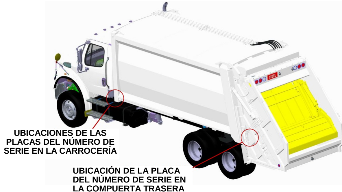
Figura 2. Ubicaciones de las placas del número de serie
