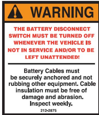
Figura 25 Advertencia: Interruptor de desconexión de la batería, NP 212-2875
