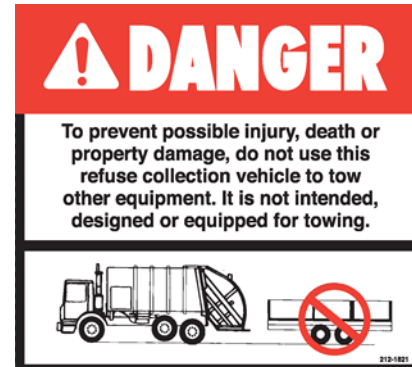
Figura 11. Peligro: No remolcar, NP 212-1821
