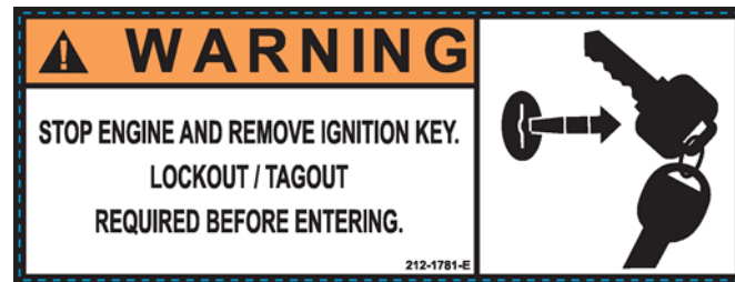
Figura 7. Advertencia: Bloqueo/etiquetado, NP 212-1781-E
