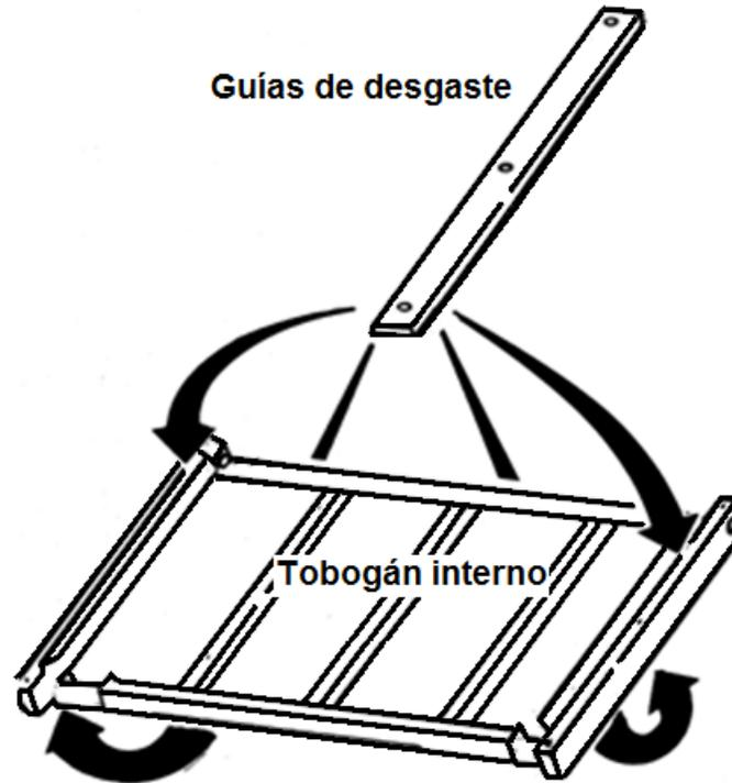
**Figura 15. Guías de desgaste para el tobogán**
