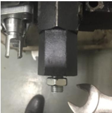
3. Si el panel eyector se atasca antes de llegar a la parte delantera de la carrocería, gire el tornillo de ajuste en sentido contrario (hacia la izquierda) por 1/8.
