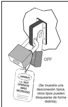
**ELÉCTRICA:** La caja del panel contiene componentes de alto voltaje. Únicamente debe permitirse el acceso al interior de la caja al personal de servicio autorizado. El personal de servicio autorizado únicamente debe poder acceder al interior de la caja tras bloquear y señalizar el transportador.
