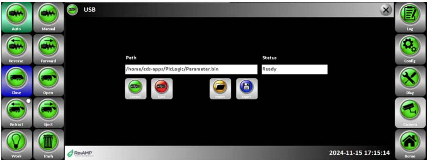
Figure 125. Parameter Save/Restore Screen
